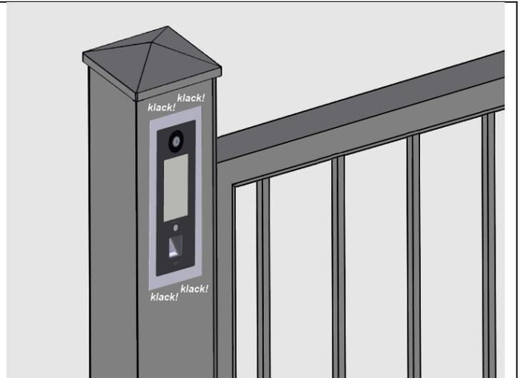
6. Um die Außenstation zu entriegeln, müssen Sie die Spitze der Montagehilfe zwischen der V2A Blende und der Pfostenoberfläche, durch die sich in dem Rahmen befindlichen Entriegelungsöffnungen schieben und mit leichtem Druck die Klemmhaken entriegeln.
